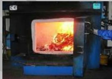
Сжигание (частично пиролиз) твердых, жидких и пастообразных отходов
